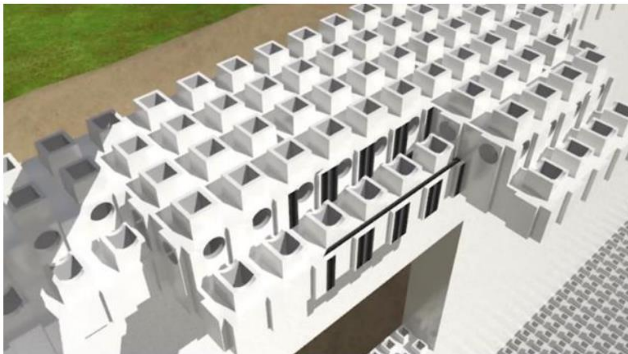
اجرای سقف با آجرهای هوشمند
